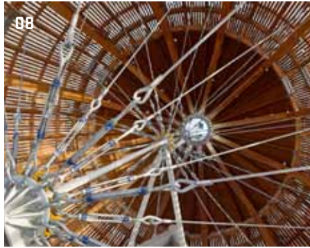
08 &gt; Výztužný lanový systém v koncových částech vzducholodi
